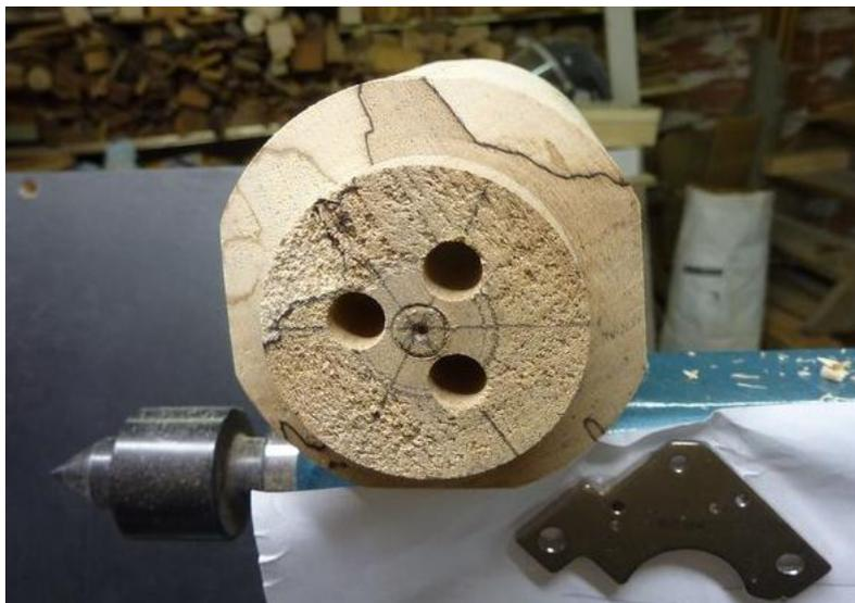
Désaxer la pièce au maximum en mettant la contre pointe en place et en gardant une prise complète des mâchoires, marquer la prise.
